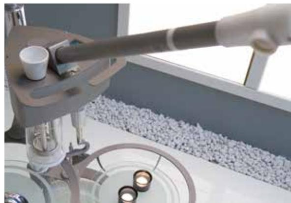
Verdampferarm mit drehbarem Kopf
